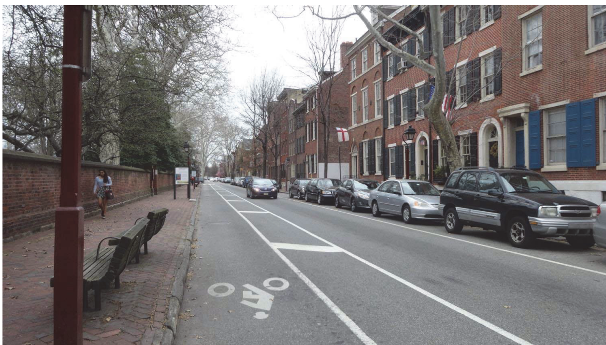
Εικ. 4: «Λωρίδα ποδηλάτου και προστατευτική νησίδα με απλή διαγράμμιση – Philadelphia Μάρτιος 2016»
