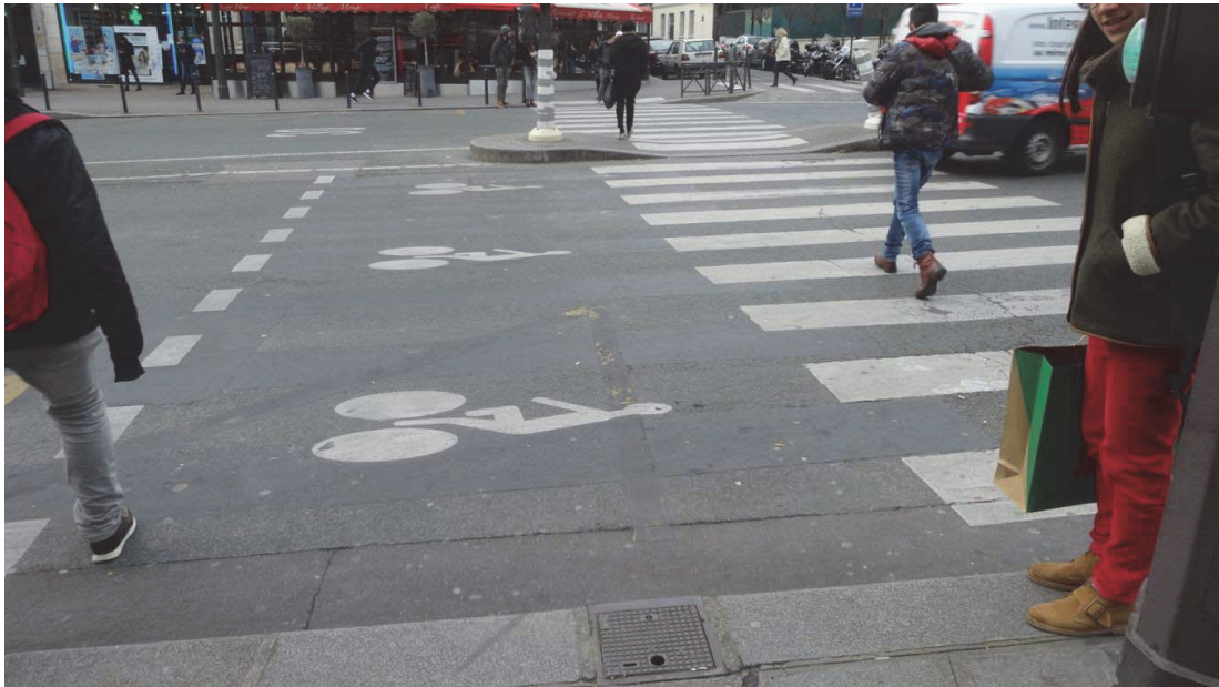
Εικ. 5: «"Ζώνη αναμονής ποδηλάτων – cycle box" μπροστά από τα αυτοκίνητα σε φωτεινή σηματοδότηση" – Παρίσι, Ιανουάριος 2016 »
